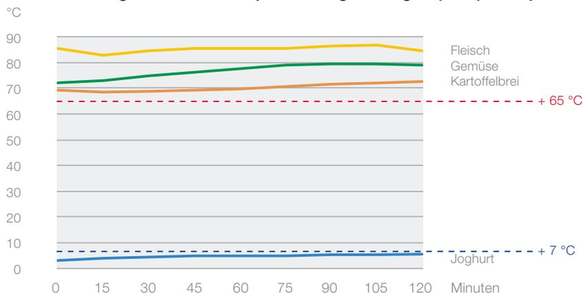
Messung der Speisentemperatur mittels Temperaturfühler. Beheizbarer SAG mit einem beheizten und einem passiv gekühlten Schrankfach.
